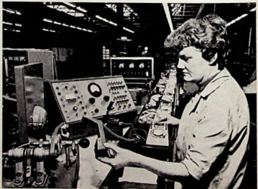
Een inspectrice van Standard Telephone and Cables (STC) controleert in de fabriek te Larne (Noord-Ierland) een „trimphone” telefoontoestel op het juiste geluidsniveau. STC heeft van de Britse PTT een order ter waarde van £ 1,9 miljoen voor levering van ettelijke duizenden toestellen verworven. De „trimphone”, ontwikkeld door STC en bedoeld voor normaal gebruik in Engeland, won een prijs voor industriële vormgeving in 1966. Het toestel neemt de helft van de ruimte in en weegt de helft van een conventioneel toestel: de „trimphone” „sluit” in plaats van het vertrouwde rinkelen en heeft een verlichte kiesschijf.
